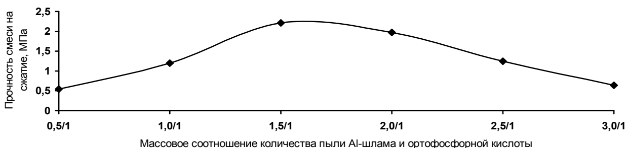
Рис. 5. Зависимость прочности затвердевшей (24 ч) алюмофосфатной ХТС от соотношения содержания компонентов
